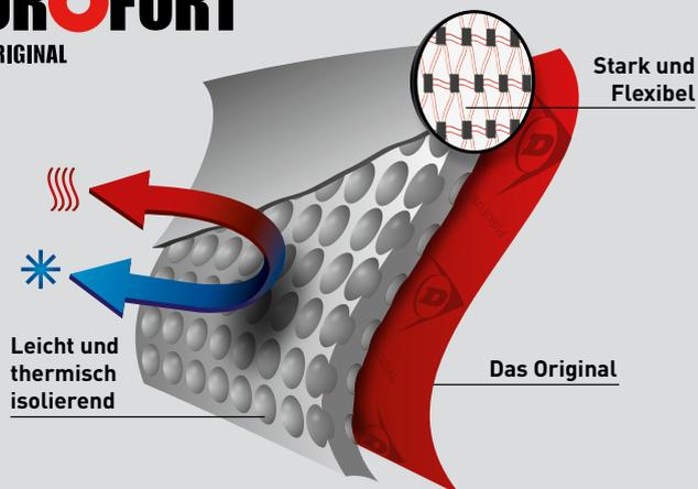
Purofort® ist das einzigartige Dunlop® Material mit Millionen gleichmäßig verteilten Luftkammern, das unsere Stiefel leicht macht und ihnen thermische Isolierung verleiht. Darüber hinaus sorgt eine vernetzte Struktur für Flexibilität und Stabilität.
